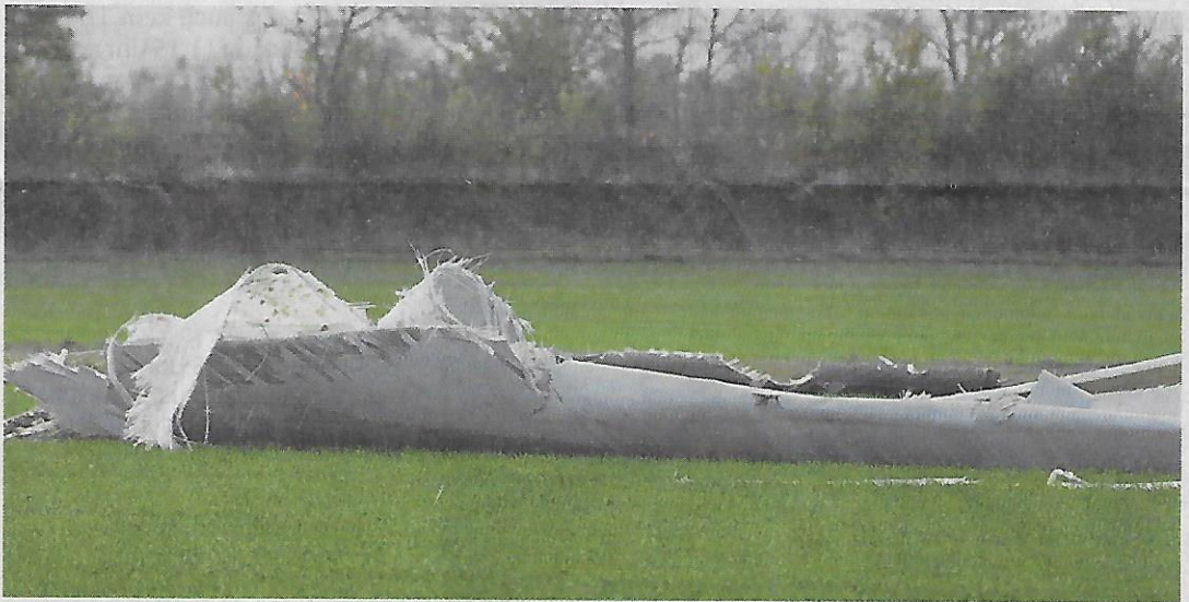
Eins der drei Rotorblätter ist komplett vom Windrad abgerissen und liegt unterhalb der Anlage auf einem Feld. Der Schaden dürfte in die Millionen gehen.
