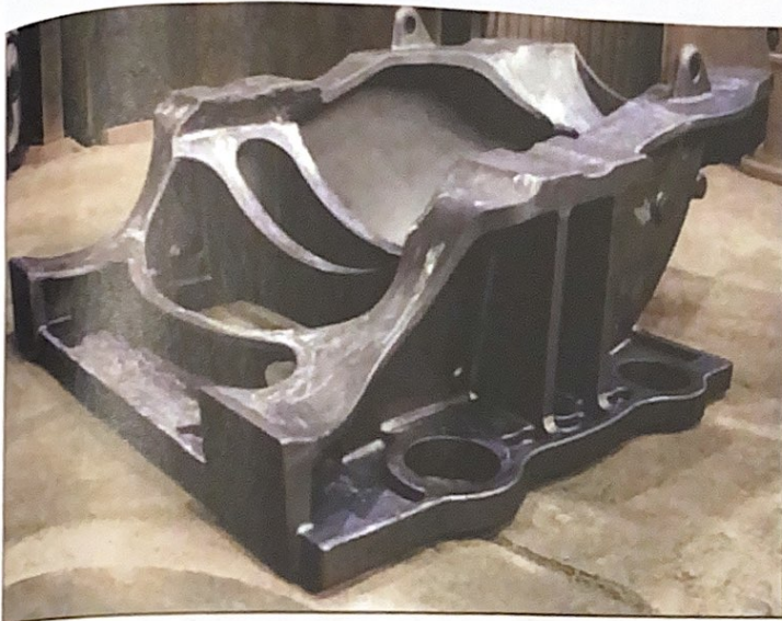
Ebenfalls aus Stahlguss bestehen die Verbindungsstücke zwischen Nabe und Turm: Hier der Grundrahmen einer Zwei-Megawatt-Anlage. Sie wiegt 8,65 Tonnen
